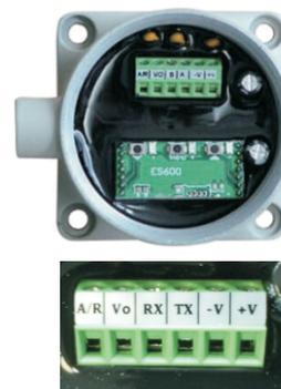
模拟信号~电压输出接线: V+, V-, Vo
