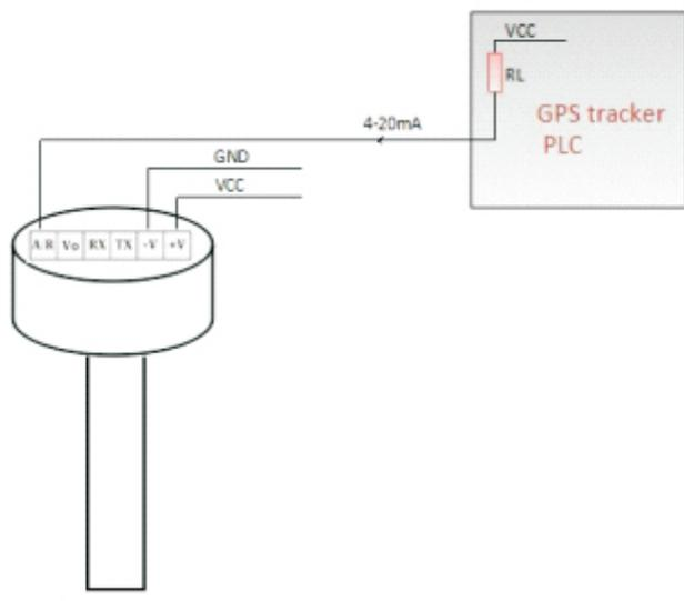
模拟信号 电阻信号输出接线 : V+ , V- , A/R
